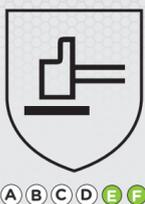
La méthode d'essai de l'EN 388, basée uniquement sur le Coup test, entraînait parfois l'attribution du niveau de coupeure 5 à deux gants différents. Avec le test de la méthode ISO 13997 en revanche, dans lequel la machine TDM est utilisée, l'un des gants pouvait atteindre un niveau de coupeure 5/C et l'autre 5/E, soit une différence de force de près de 2 000 grammes ! Les nouveaux niveaux facilitent grandement l'identification des différents degrés de protection contre les coupures.
