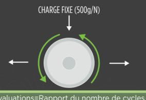
En utilisant une lame circulaire qui se déplace d'avant en arrière et sous une charge fixe de 500 grammes, la machine d'essai de coupe mesure le rapport du nombre de cycles requis pour couper l'échantillon d'essai par rapport au matériau de référence.
