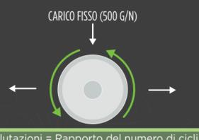
Utilizzando una lama circolare che si muove avanti e indietro e con un carico fisso di 500 grammi, la macchina per il Coup Test calcola il numero di cicli necessario per penetrare nel tessuto del campione.
