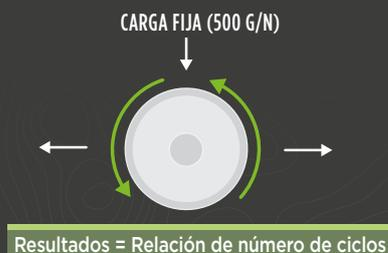
Con una cuchilla circular que se desplaza hacia delante y hacia atrás con una carga fija de 500 gramos, la máquina de prueba Coup mide la relación del número de ciclos necesarios para realizar un corte en una muestra de prueba en comparación con el material de referencia.
