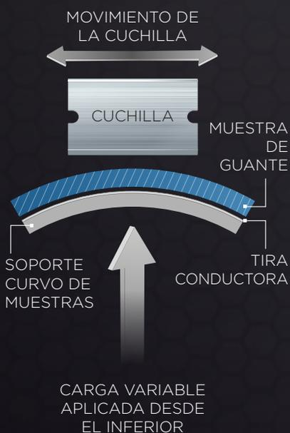
El estándar EN 388:2016 de equipos de protección contra riesgos metálicos incluye el método de prueba internacional ISO 13997. El sector textil utiliza este método de prueba para conocer mejor los niveles de protección. Se realizan pruebas en una muestra de guante con una cuchilla con carga variable en una máquina TDM (Tomo Dynamo Meter). La resistencia a cortes se expresa como la fuerza de corte en newtons (N).
